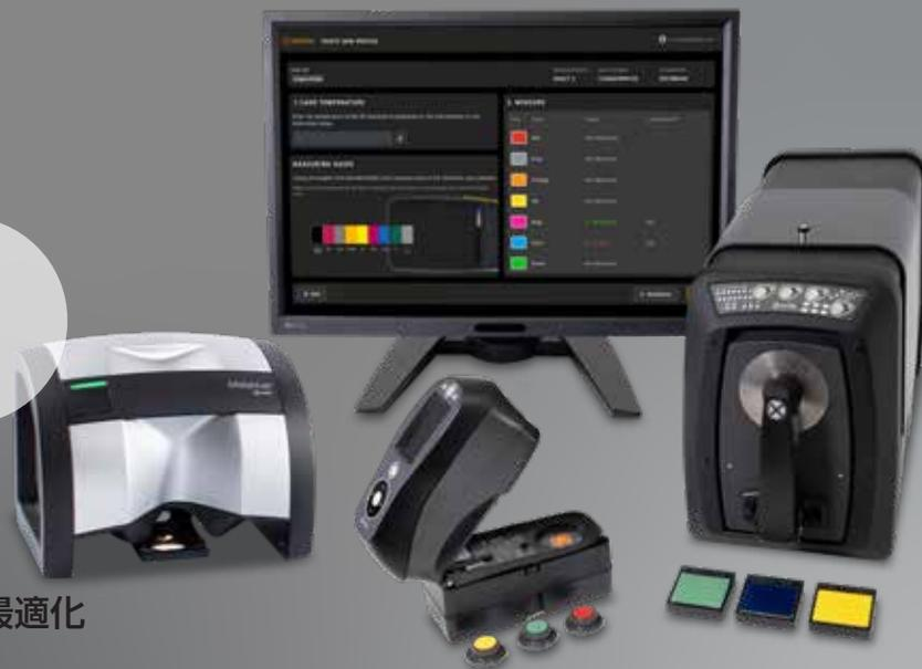
産業用測色計向けのNetProfilerは、お客様のお手元で定期的に測色計の測定精度を検証最適化するためのツールです。X-Rite社へ機器を送り返すことなく、簡単操作で測定精度を検証し、最適化テーブルを機器へセットします。
