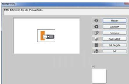
Über diesen Knopf gelangt man auf die Pantone Datenbank. Es werden entsprechend der selektierten Farbpalette verschiedene Farbkollektionen ausgegeben, die mit diversen Filtern – wie zum Beispiel Druckprozess oder Substrat – eingeschränkt werden können.
