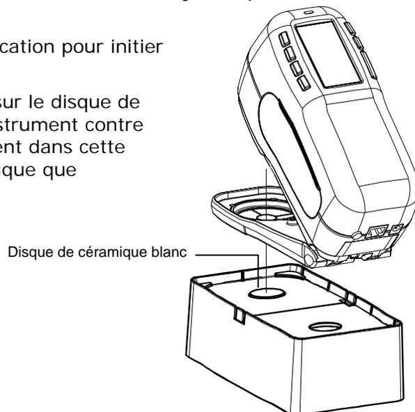
4. Positionnez maintenant la fenêtre cible de l'instrument sur l'ouverture du piège à lumière et abaissez le corps de l'instrument contre sa semelle. Maintenez fermement l'instrument dans cette position jusqu'à ce que votre ordinateur indique que l'étalonnage du noir est terminé.
