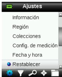
2. Presione el botón **Entrar**. Un mensaje le pide que confirme el restablecimiento del dispositivo a sus valores originales de fábrica.
