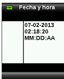
2. Para configurar el atributo seleccionado, presione los lados arriba y abajo del control de **Navegación**. Luego de seleccionar el formato, para alternar entre los formatos MM:DD:AA y DD:MM:AA, presione los lados arriba y abajo del control de **Navegación**.
