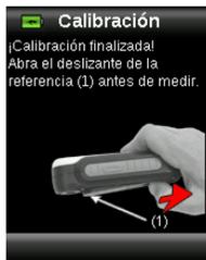
**Nota:** aparece un mensaje de error si la tapa deslizante de la referencia blanca no se encuentra en la posición correcta para la calibración. Si esto ocurre, cierre la tapa y repita el procedimiento de calibración. Si este mensaje sigue apareciendo después de volver a calibrar, consulte la sección Solución de Problemas en los Apéndices.
