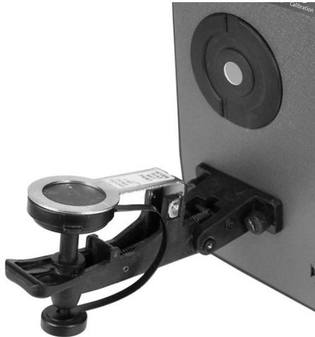
7. Realice el procedimiento de calibración del color negro (con el puerto abierto) por medio del software. El indicador del estado cambia del color ámbar a non encendido (off) y el indicador de calibración cambia al color verde. Esta es una indicación de que el procedimiento de calibración se ha realizado correctamente.
