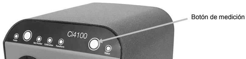
El indicador de estado cambia al color rojo y se produce un pitido de error si la medición no se ha realizado correctamente. Consulte la sección Solución de problemas en los Apéndices para obtener más detalles.
