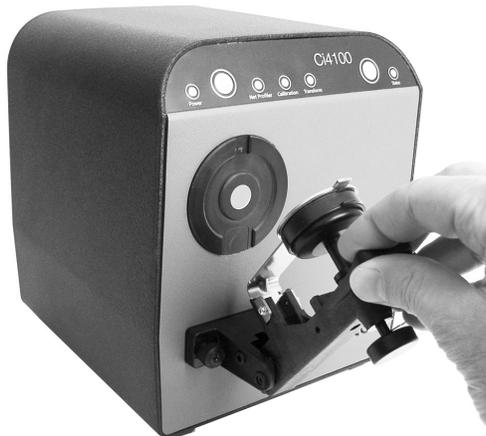
3. Estire la manija e inserte la muestra de color entre el sujetador y el retén. Asegúrese de que el lado de la muestra que desea medir esté mirando al puerto de muestreo.
