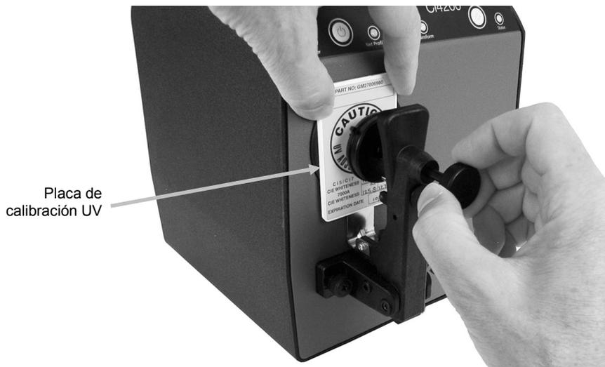
4. Cierre el sujetador del portamuestras en contra de la placa de calibración UV.
