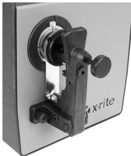
4. Realice el procedimiento de calibración del color blanco por medio de la aplicación del software. El indicador de estado cambia al color ámbar. El indicador de calibración debe cambiar al color rojo.
