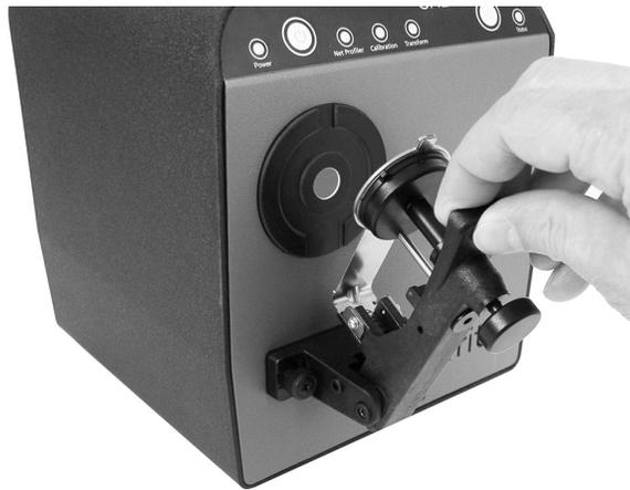
3. Estire la manija e inserte la muestra de color entre el sujetador y el retén. Asegúrese de que el lado de la muestra que desea medir esté mirando al puerto de muestreo.
