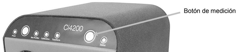
El indicador de estado cambia al color rojo y se produce un pitido de error si la medición no se ha realizado correctamente. Consulte la sección Solución de problemas en los Apéndices para obtener más detalles.
