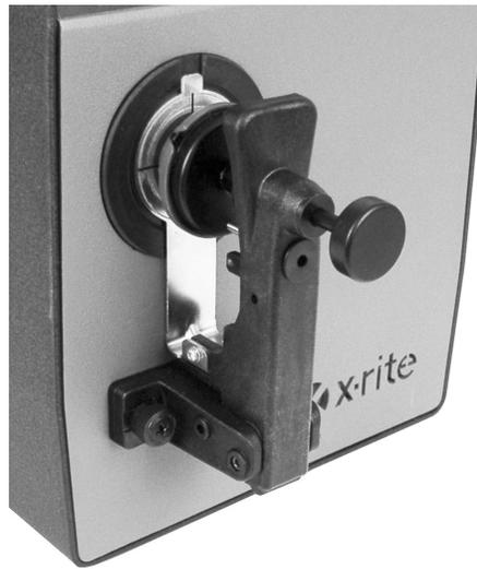
4. Inicie o procedimento de calibração do branco a partir do aplicativo do programa. A cor do indicador de estado muda para âmbar. A cor do indicador da calibração deveria mudar para vermelho.
