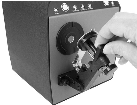
3. Acione o puxador para trás e insira a amostra colorida entre a garra e o retentor. Certifique-se de que o lado da amostra que você quer medir esteja de frente para a abertura de medição (porta de amostragem).
