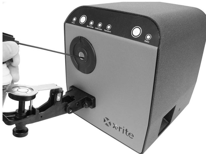
**IMPORTANTE:** se for usar uma lata de ar comprimido para a limpeza, não use-a de cabeça para baixo nem inclinada. Se usá-la destas formas, poderá causar danos aos componentes ópticos do instrumento.
