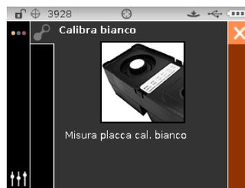
6. Premere e tenere premuto lo strumento con fermezza contro la base finché il display non indichi che la lettura sia completata. Rilasciare lo strumento.
