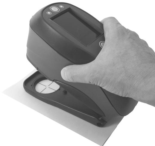
3. Premere e tenere premuto lo strumento con fermezza contro la base finché il display non indichi che la misura sia completata.
