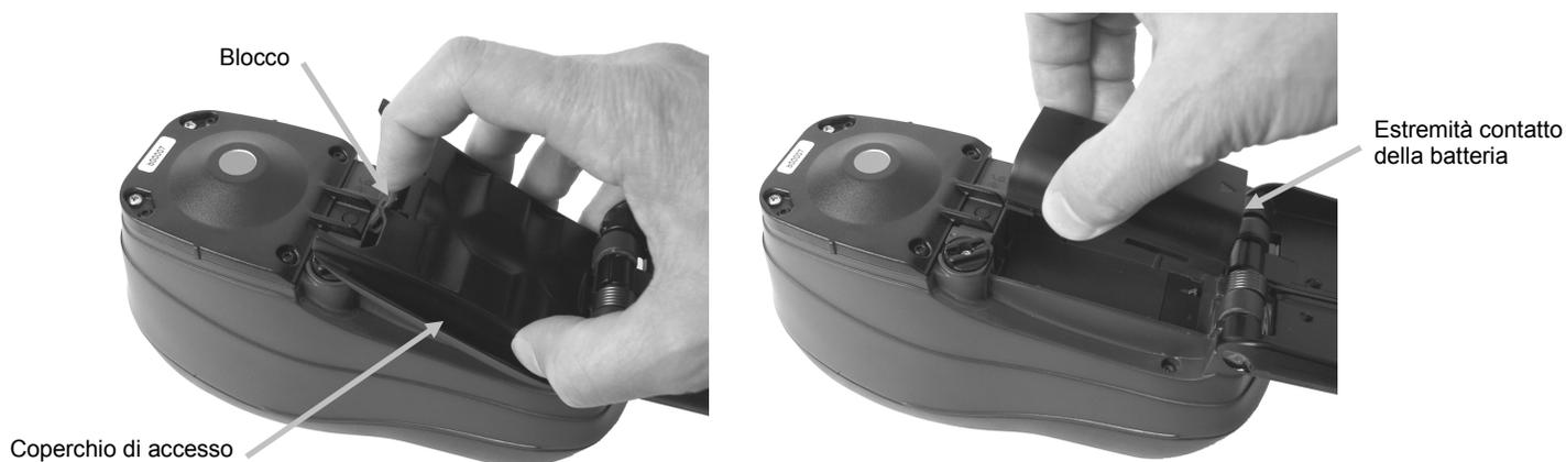
5. Reinstallare il coperchio di accesso alle batterie inserendo il bordo posteriore e poi premendo verso il basso fino a quando il coperchio di accesso non si blocchi in posizione.
