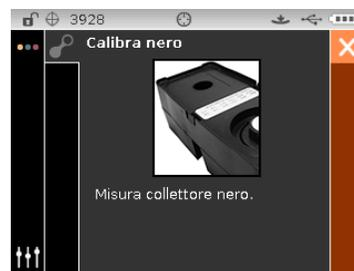
9. Premere e tenere premuto lo strumento con fermezza contro la base finché il display non indichi che la lettura sia completata. Rilasciare lo strumento.
