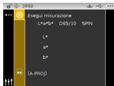
3. Posizionare lo strumento sul campione tramite le procedure spiegate in precedenza.
