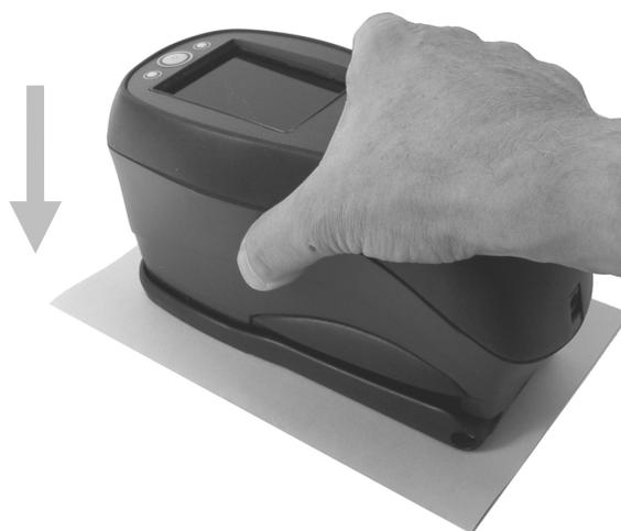
4. Rilasciare lo strumento e visualizzare i risultati della misurazione.
