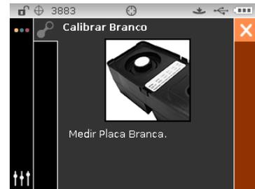
6. Pressione o instrumento firmemente contra a sapata e mantenha-o imóvel até que o visor indique o término da leitura. Libere o instrumento.
