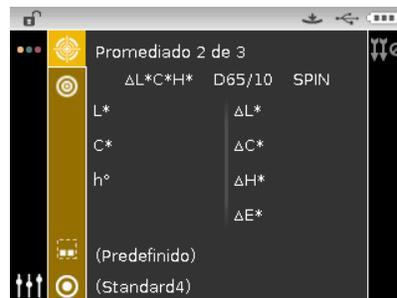
11. Coloque el instrumento sobre la tercera parte de la muestra y realice una medición. Después de la medición, momentáneamente el instrumento muestra "Procesando" y, a continuación, los valores del promedio de los datos de la muestra y los valores de la diferencia.
