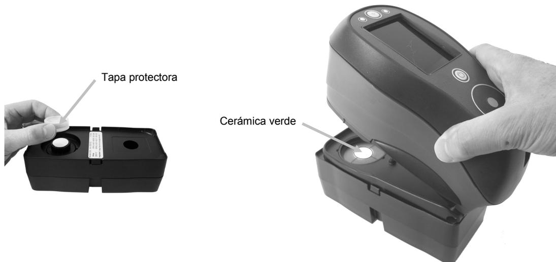
5. Presione firmemente el instrumento en la zapata. Manténgalo quieto hasta que la pantalla indique que se completó la lectura.
