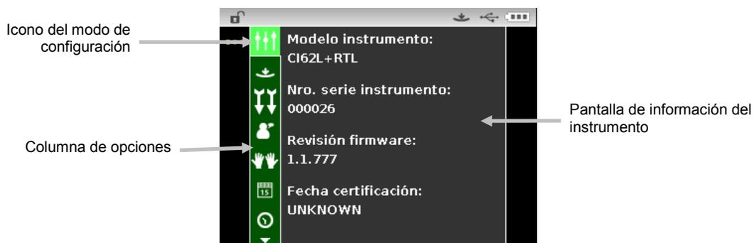
3. Utilice los botones de navegación **Arriba** o **Abajo** en la pantalla de Configuración para resaltar el icono de configuración deseado en la columna Opciones.
