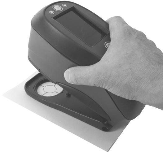
3. Baje el instrumento hasta la zapata, manteniéndolo firme hasta que la pantalla le indique que la medición esté completa.
