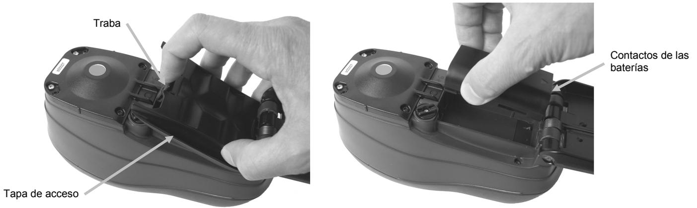
5. Vuelva a colocar la tapa de acceso a las baterías insertando primero el extremo posterior y presionando hacia abajo hasta que la tapa de acceso encaje en su posición.
