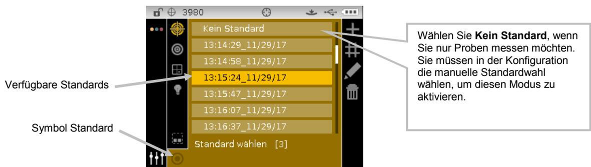
4. Verwenden Sie die Navigation nach **Oben** oder **Unten**, um die Markierung zum gewünschten Standard zu verschieben.
