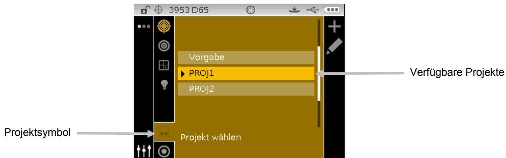
3. Verwenden Sie die Navigation nach **Oben** oder **Unten**, um die Markierung zum gewünschten Projekt zu verschieben.
