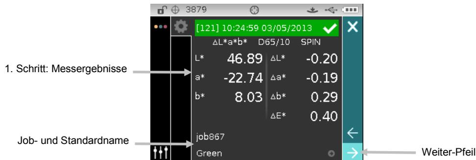
5. Folgen Sie den Anweisungen auf der Anzeige, und platzieren Sie das Gerät auf der Probe, und starten Sie die Messung.
