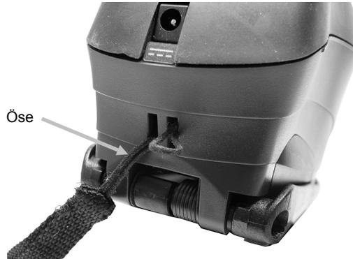
2. Führen Sie anschließend die Handschlaufe durch die Öse.
