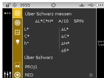
5. Probe über dem schwarzen Teil der Opazitätskarte messen. Lassen Sie das Gerät los, wenn die Werte angezeigt werden.
