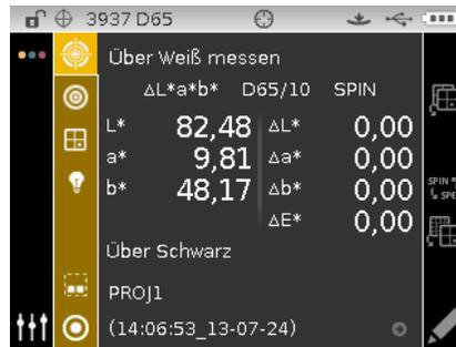
6. Probe über dem weißen Teil der Opazitätskarte messen. Lassen Sie das Gerät los, wenn die Werte angezeigt werden.
