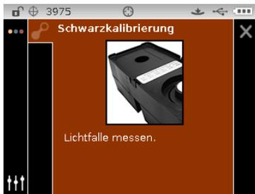
10. Drücken Sie das Gerät solange gegen den Fuß, bis im Display angezeigt wird, dass der Messvorgang abgeschlossen ist. Lassen Sie das Gerät wieder los.
