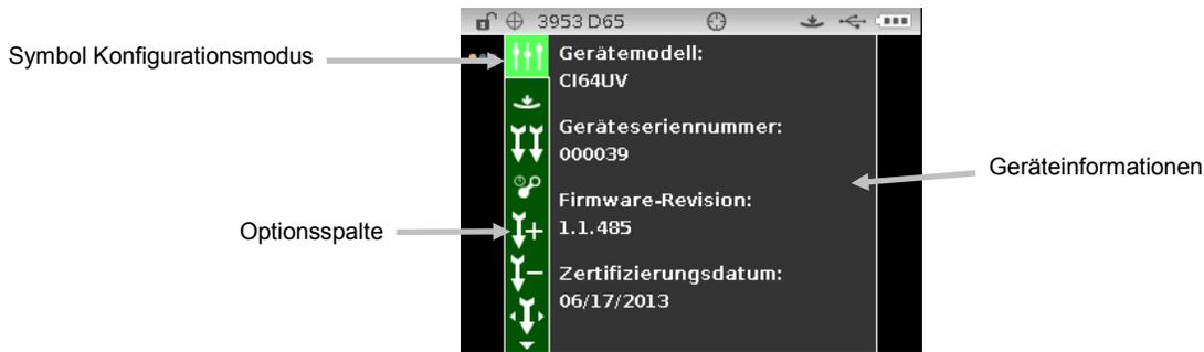
3. Verwenden Sie die Pfeiltasten nach **Oben** oder **Unten**, um die Markierung zum gewünschten Konfigurationselement in der Optionsspalte zu bewegen.
