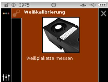
7. Drücken Sie das Gerät solange gegen den Fuß, bis im Display angezeigt wird, dass der Messvorgang abgeschlossen ist. Lassen Sie das Gerät wieder los.
