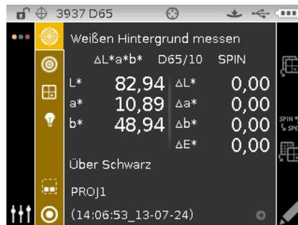
7. Messen Sie den weißen Hintergrund der Opazitätskarte. Lassen Sie das Gerät los, wenn die Werte angezeigt werden.
