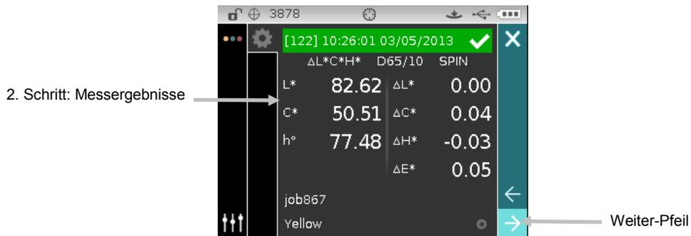
7. Folgen Sie den Anweisungen auf der Anzeige, und platzieren Sie das Gerät auf der Probe, und starten Sie die Messung.
