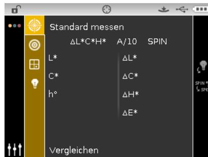
4. Platzieren Sie das Gerät auf dem Standard, und starten Sie die Messung.
