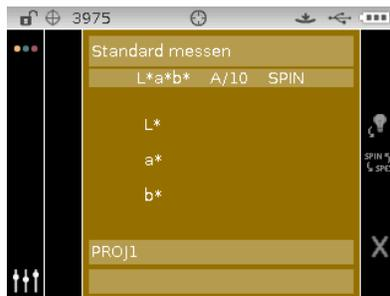
2. Platzieren Sie das Zielfenster auf der Probe, und starten Sie die Messung.
