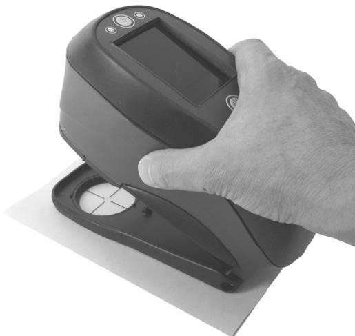
3. Pressione o instrumento firmemente contra a sapata e mantenha-o imóvel até que o visor indique o término da medição.
