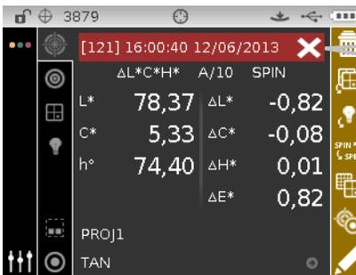
Um "X" branco e a barra vermelha indicam que a amostra está fora da tolerância (falha).
