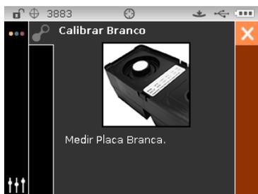
7. Pressione o instrumento firmemente contra a sapata e mantenha-o imóvel até que o visor indique o término da leitura. Libere o instrumento.
