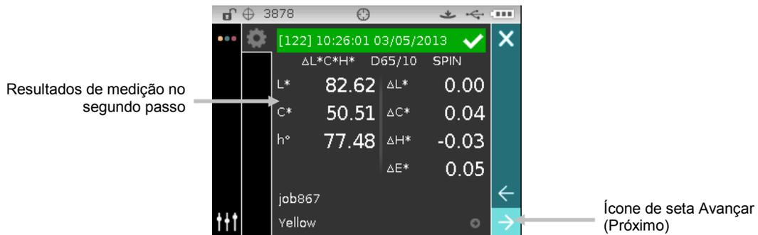
7. Posicione o instrumento sobre a amostra conforme descrito na tela e faça a medição.
