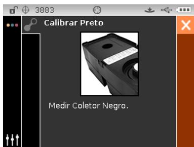
10. Pressione o instrumento firmemente contra a sapata e mantenha-o imóvel até que o visor indique o término da leitura. Libere o instrumento.
