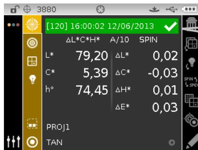
A "marca de tique" branca e a barra verde indicam que a amostra está dentro da tolerância (passa).
