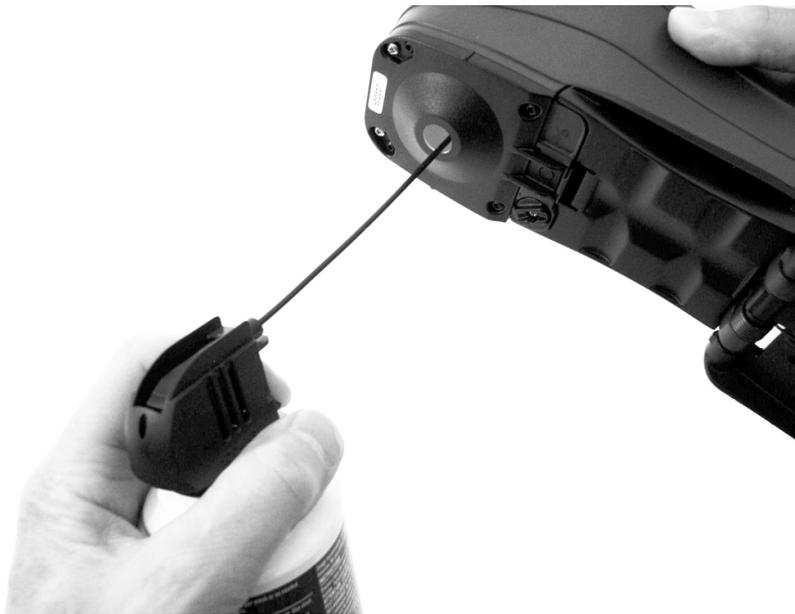
**IMPORTANTE:** se for usar uma lata de ar comprimido para a limpeza, não use-a de cabeça para baixo nem inclinada. Se usá-la destas formas, poderá causar danos aos componentes ópticos do instrumento.
