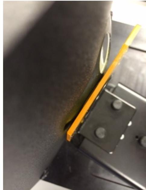
**Transmissionshalter mit Probe an der Kugel (totale Messung) für 25, 17, 10 und 6 mm Messungen**
