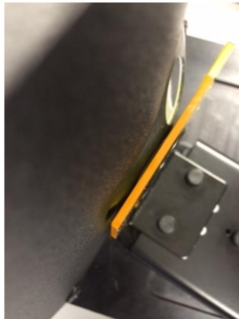
9. Una volta posizionato correttamente, serrare le viti con le dita e chiudere il coperchio di trasmittanza.
