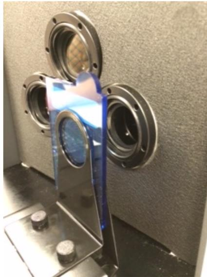
7. Una volta posizionato correttamente, serrare le viti con le dita e chiudere il coperchio di trasmittanza.
