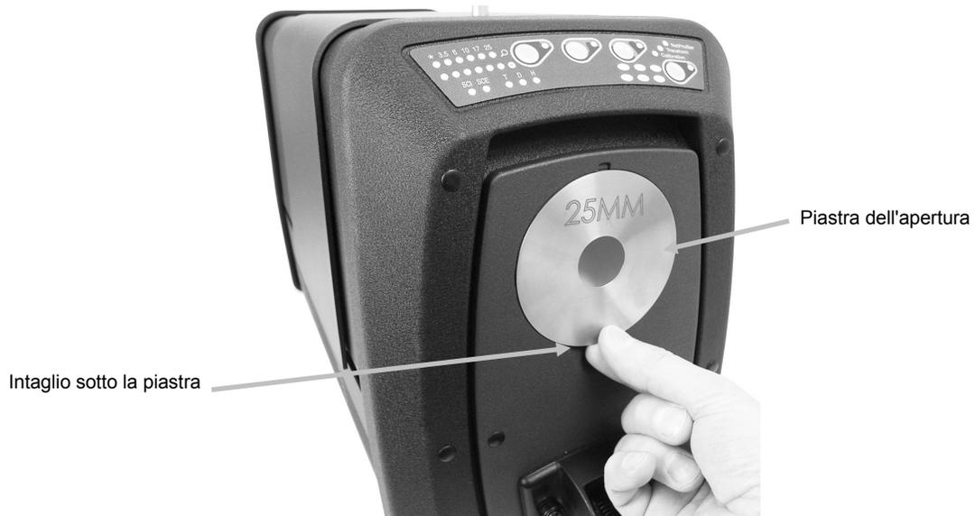
3. Individuare nel cassetto di accessori la piastra da installare e collocare l'apertura sul bordo dello sportello del campione. La piastra è tenuta in posizione da magneti.
