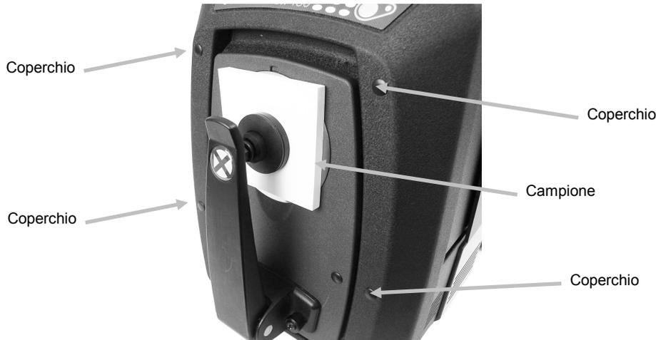
6. Usare lo schermo del computer oppure la porta di visualizzazione per visualizzare il campione e regolarne l'area di misurazione.
