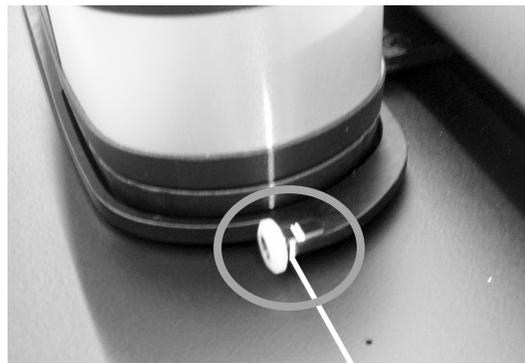
3. Si la línea de láser está en la parte posterior de la marca de trazo blanco, gire la rueda de ajuste de la alineación hacia arriba para centrar la línea de láser en la marca de trazo blanco.
