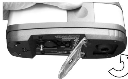
3. Posicione la ventana de mira del instrumento sobre la muestra que va a medir. La abertura de medición debe ser cubierta completamente por el color de la muestra.
