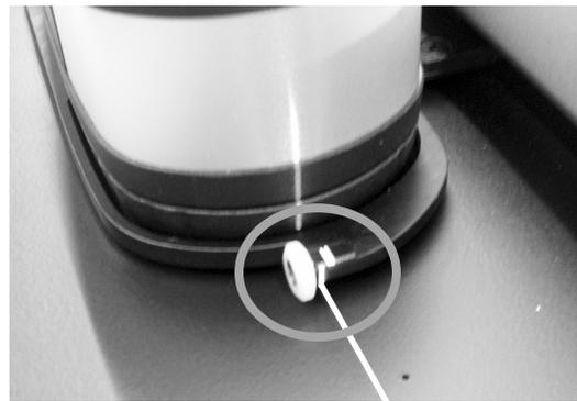
3. Se la linea del laser si trova nella parte posteriore del segno di trattino bianco, ruotare la rotella di regolazione dell'allineamento verso l'alto per centrare la linea del laser sul segno di trattino bianco. Se la linea del laser si trova nella parte anteriore del segno di trattino bianco, ruotare la rotella di regolazione dell'allineamento verso il basso per centrare la linea del laser sul segno di trattino bianco.
