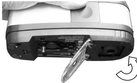
3. Collocare la finestra del target sul campione da misurare. L'apertura dovrebbe essere completamente piena del colore del campione.
