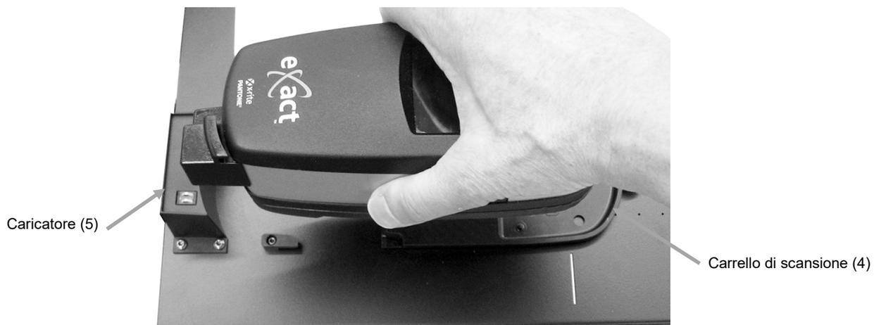
7. Fissare lo strumento eXact al carrello di scansione ruotando il braccio di blocco (6) in senso antiorario finché non si arresta. Ciò mantiene lo strumento in posizione durante la scansione.
