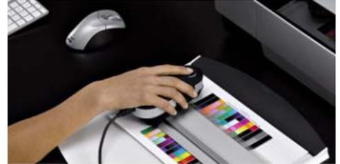
Si le logiciel indique que votre instrument n'est pas étalonné, appuyez sur le bouton **Étalonner** pour étalonner l'i1. Vérifiez que votre i1Pro est positionné correctement sur le carreau blanc d'étalonnage. L'étalonnage peut prendre environ une minute.
