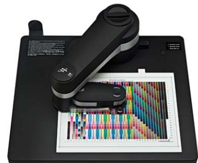
**Conseil :** Aucune lumière ne doit s'échapper de l'optique lorsque l'i1iO prend des mesures. Si ce n'est pas le cas, arrêtez la mesure et repositionnez l'i1Pro.
