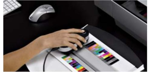
Se il software indica che lo strumento i1 non è calibrato, premere il pulsante **Calibrate** per calibrarlo. Accertarsi che il dispositivo i1Pro sia posizionato correttamente sulla ceramica bianca di calibrazione. Questa operazione potrebbe richiedere un minuto.
