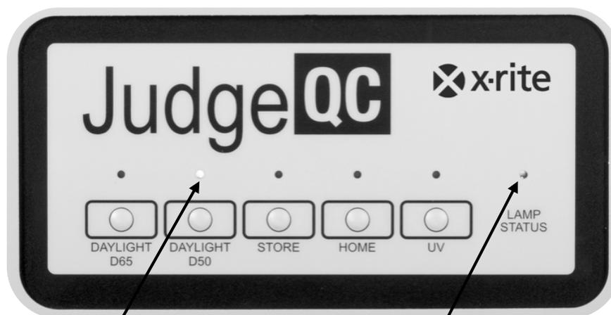
Voyant de source lumineuse : une lumière *bleue* indique la source lumineuse sélectionnée.
