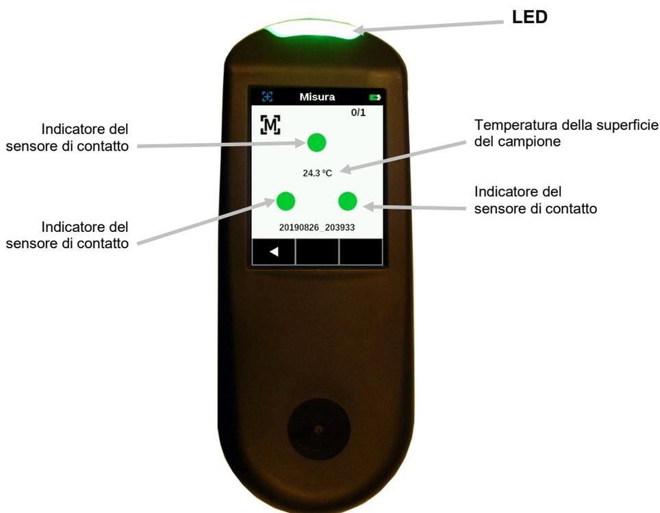
I LED multicolori situati sulla parte frontale dello strumento forniscono informazioni visiva sullo stato delle misurazioni e dei sensori di contatto.
