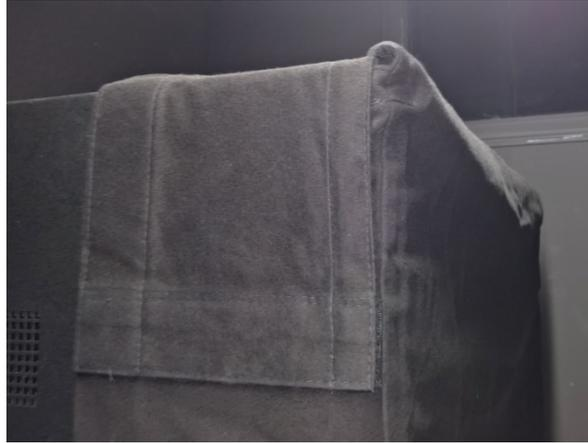
16. Hängen Sie den Kalibriervorhang über die VLB, so dass die Vorderseite komplett abgedeckt ist.
